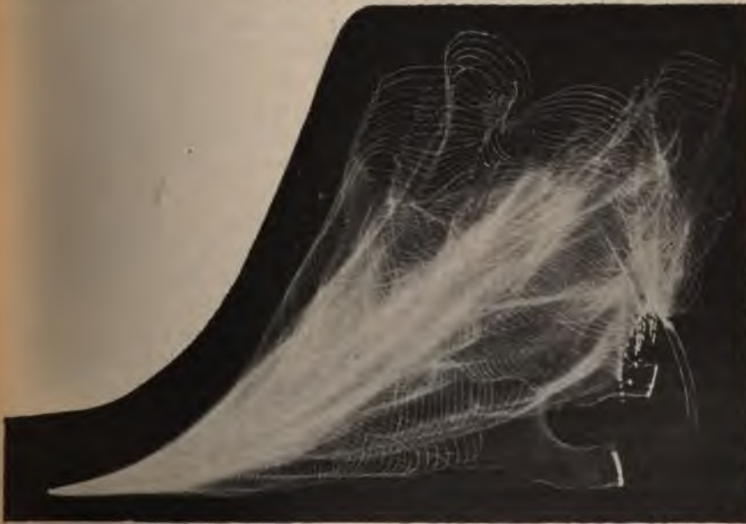
Abb. 279a. Funkenentladung eines Induktors mit elektrolytischem Unterbrecher.
